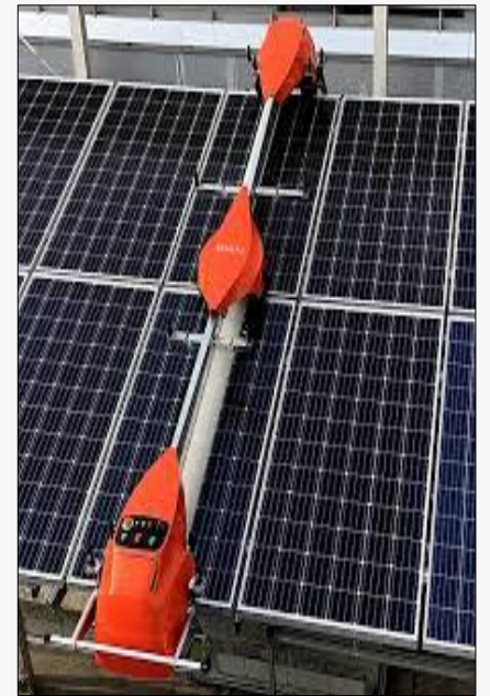
شست و شوی اتوماتیک پنل های خورشیدی با روبات های متصل به سازه ها
